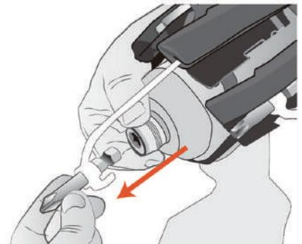
使用後はビットを取り外せば自動的にビットが収納されます。
