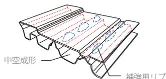
ホームデザイン物置、キャビネット、デッキボックス（型番 BM シリーズ）は強度・安定性、断熱性に優れたブロー成形（中空成形）による2重壁構造を採用しています。
