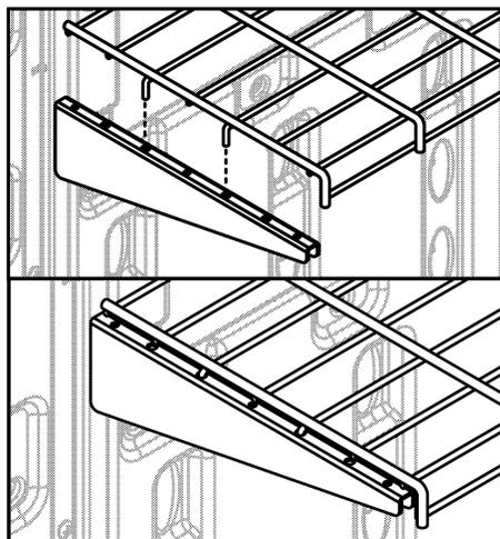
7. 手順5で差し込んだクランプとシェルフブラケットを木ネジ (D) を利用して固定します。
