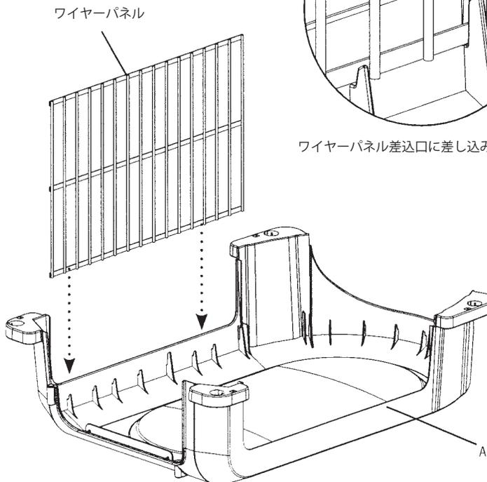
2. 慎重にワイヤーパネルをボトムパネル A (Bottom Panel A) の後方部のカーブに合わせて曲げます。そのままボトムパネルの差込位置に合わせて差し込みます。
