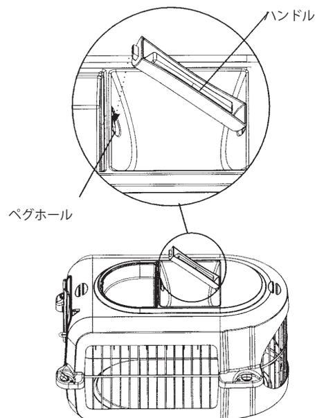
7. 図のようにトップパネルに小物入れフタ (Storage Lid D) を取り付けます。片方のペグホールにペグを挿入します。もう片方も同様に差し込みます。差込み時少しフタを曲げて入れると入れやすいです。曲げすぎると破損の恐れがありますので、注意してください。
