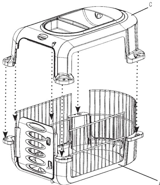
5. コネクタ穴の溝に合わせてコネクタを挿入して時計回りに4分の1コネクタを回します。
