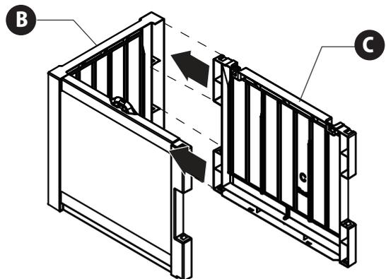
**3** 図を参考にフロントパネル(A)とバックパネル(C)をサイドパネル(B)の対応する穴に入れパチンと音がするまで差し込みます。
