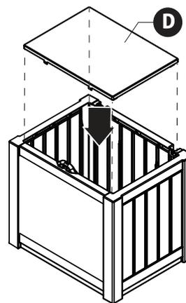
**5** バックパネルを正面にするように本体を置きます。トップパネル(E)のヒンジタブをバックパネル(C)のヒンジペグに上からはめ込みます。
