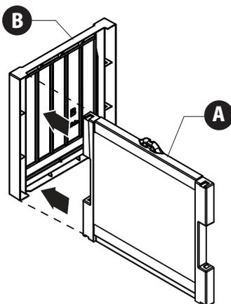
**2** バックパネル(C)をサイドパネル (B) の対応する穴に入れパチンと音がするまで差し込みます。
