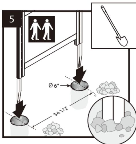
間を約88cm開けて、直径15cm、深さ30cmの穴を2つ掘ります。その穴に杭Dを差し込みます。
