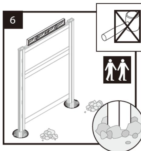
パネルが水平であることを確認し、穴を埋めてください。水平でない場合は、一度パネルを取り外し、穴の深さなどを調整してください。
