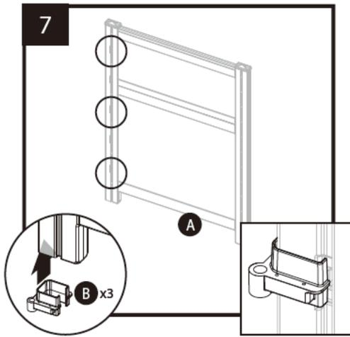
新しく設置するパネルAに組立①と同様、コネクタBを取り付けます。※3枚以上設置する場合はもう片側にもコネクタBを取り付けてください。
