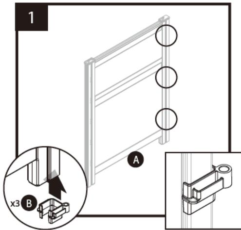
パネルAの側面にコネクタBを取り付けます。
