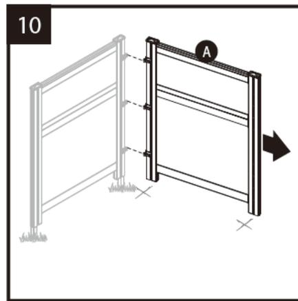
パネル同士を接続しない場合はステップ2～6の手順で設置します。
