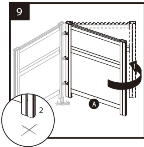
パネルAを目的の場所に置き、杭Dの位置をマークし、ステップ2～6の手順で設置します。
