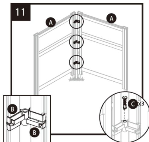
接続ピンCをパネルコネクタに差し、パネル同士を接続します。追加で設置する場合もステップ7～11の手順で設置します。
