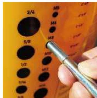
DIYなどに最適な多くの単位の変換一覧、簡易定規、ホールゲージなどを記載
